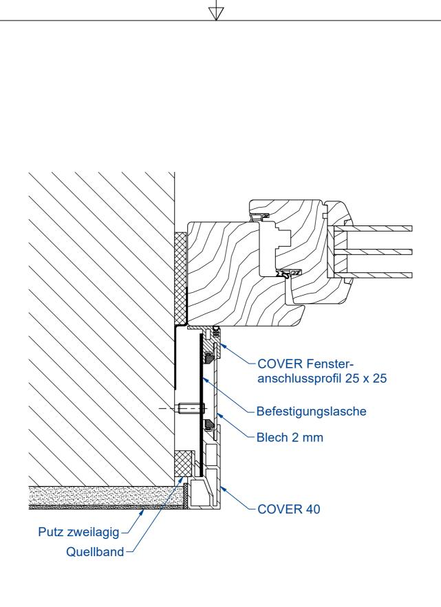
Einbausituation Laibungs- und Befestigungszargen Holzfenster - Einbau mittig - Eckprofil COVER 40
