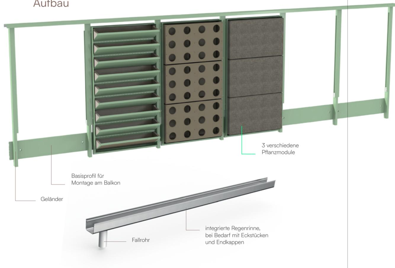
Modulhalterung zum Einschrauben in das Geländer (Revisionssystem)
