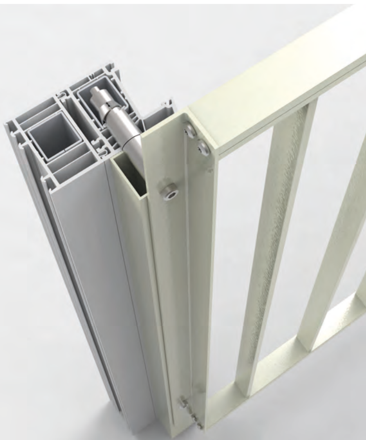
ABSTURZSICHERUNG SIMPLUM AUF EINEM KUNSTSTOFFFENSTER IN KOMBINATION MIT ROLLLADENFÜHRUNGSSCHIENE. BEFESTIGUNG MIT DEM PROFILDÜBEL CAVUS.
